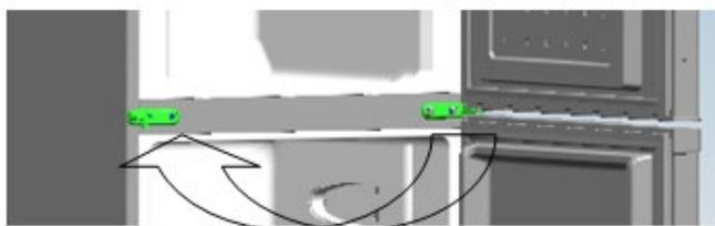
8) Ajuste la posición correcta de la puerta inferior y fije la bisagra central.
