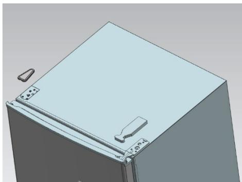
2) Con un destornillador cruciforme, afloje los tornillos de la bisagra superior.
