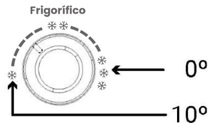
La primera vez que ponga en funcionamiento el frigorífico, ajuste el termostato en “\*\*\*” y déjelo funcionar sin alimentos durante 4 horas antes de guardarlos para que se enfríen lo suficiente.
