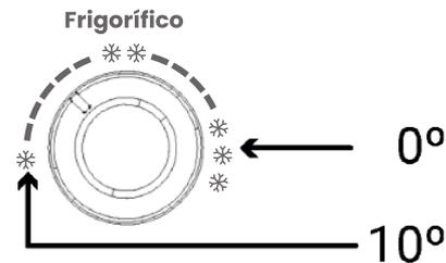
La primera vez que ponga en funcionamiento el frigorífico, ajuste el termostato en “\*” y déjelo funcionar sin alimentos durante 4 horas antes de guardarlos para que se enfríen lo suficiente.
