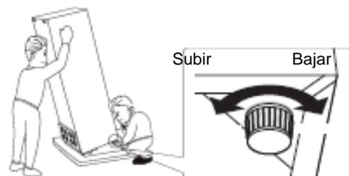
Procedimiento de ajuste de las patas delanteras
