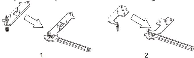
6. Instale la bisagra inferior bajo el frigorífico como se muestra a continuación, atornillando las patas de ajuste, asegúrese de que está perfectamente horizontal.
