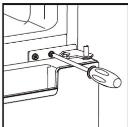
4. Al instalar el frigorífico, retire las bases de ajuste como se indica a continuación y retire la bisagra inferior con un destornillador de estrella.
