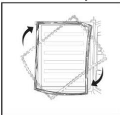
8. Retire los retenedores de las puertas superior e inferior, saque los nuevos retenedores de la bolsa de accesorios (junto con el manual) y colóquelos en el lado opuesto.
