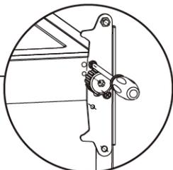
5. Ajuste de la posición central de la bisagra inferior y superior a la posición opuesta
