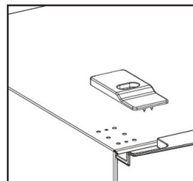
3. Quite la puerta superior, saque el tornillo de la bisagra central con un destornillador cruzado y retire la puerta inferior.
