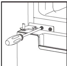
10. Vuelva a colocar la puerta superior. Compruebe que la puerta queda alineada horizontal y verticalmente de manera que la junta esté bien cerrada antes de apretar la bisagra superior. A continuación, inserte la bisagra superior y atorníllela a la parte superior de la unidad y fije el embellecedor de la bisagra (en la bolsa de accesorios).
