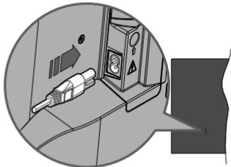
Enchufe un extremo (la clavija de dos orificios) del cable de alimentación desmontable suministrado en la entrada del cable de alimentación situada en la parte trasera del televisor, como se muestra arriba. A continuación enchufe el otro extremo del cable en la toma de corriente de la pared.
