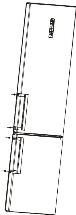
5) Retire los tornillos y baje los tiradores hacia abajo.
