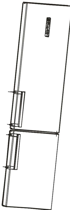
4) Remueva los tapones de la rosca de los orificios de los tornillos del tirador.
