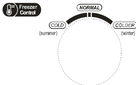
La temperatura de congelación es relativamente baja en la posición «MÁS FRÍO», mientras que la temperatura de congelación es relativamente alta en la posición «FRÍO», por lo que se suele utilizar la posición «NORMAL».
