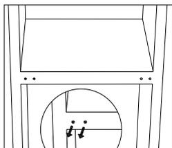
7. Tienda la parte trasera del aparato sobre una superficie acolchada y destornille la bisagra inferior y la pata de nivelación.
