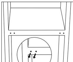
11. Tienda la parte trasera del aparato sobre una superficie acolchada y destornille la bisagra inferior y la pata de nivelación.
