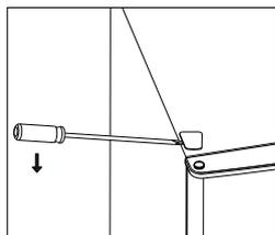
4. Cambie la tapa del lado izquierdo al derecho, después levante la puerta superior y colóquela sobre una superficie acolchada para que no se raye.
