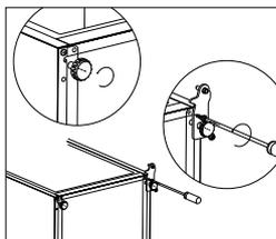
12. Ponga de pie el aparato y coloque la puerta en la bisagra inferior. Compruebe que el núcleo de la bisagra inferior esté insertado en el orificio de la puerta. Después cambie la tapa del orificio de la bisagra de la puerta inferior, del lado izquierdo al derecho.
