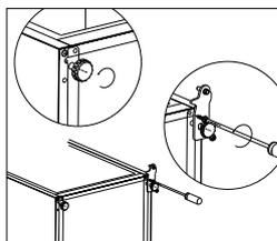
8. Destornille y extraiga el pasador de la bisagra inferior, gire la abrazadera y cámbiela.
