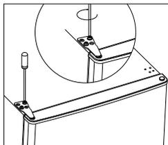
15. Golpee ligeramente la tapa de la bisagra y la tapa del orificio de la parte superior del aparato.
