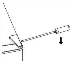
2. Destornille la bisagra superior con un destornillador Phillips.
